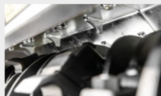
Spike Pro Gegenschneiden zur optimalen Bearbeitung des Mulchmaterials
