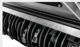
Leitklappe zum sicheren Weiterleiten des bearbeiteten Materials
